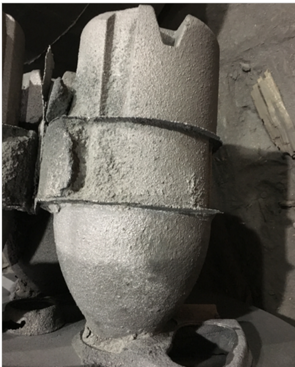
Abb. 5: Abgegossener Speiser - Modul 6,8 cm
