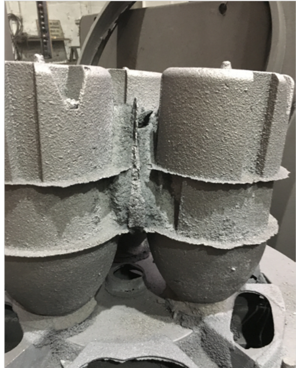
Abb. 6: Speiseranordnung - Drei Speiser - Modul 6,8 cm
